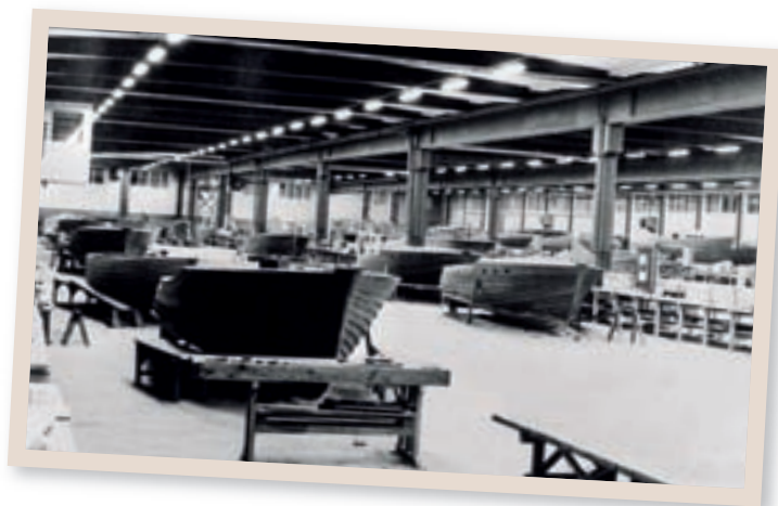
Tillverkningen av den första motorbåten, som byggdes i tre olika storlekar och försågs med Archimedes/Penta utombordsmotorer.
